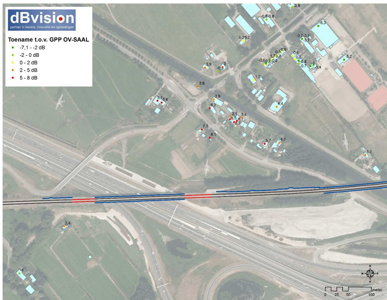
Figuur 2 Geluidtoename in de situatie met tijdelijke hulpbruggen ten opzichte van de geluidplafondwaarde die is vastgesteld in het TB OV-SAAL (vóór het TB SAA 2014)
